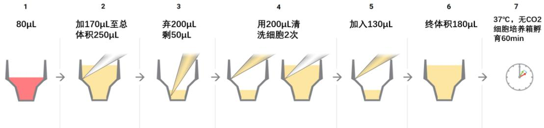
**B-Figure 3.4** 该细胞换液流程适用于黏附力较差贴壁细胞
