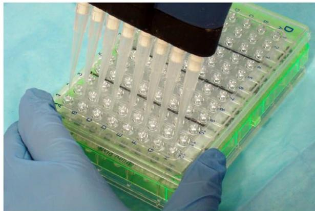
**B-Figure 4.7 加载药物时移液枪头竖直探入辅助板孔中**
