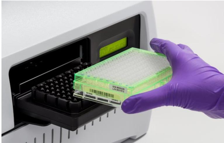
B-Figure 5.5 探针板放置方向
