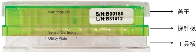
A-Figure 3.1 XFe96 探针板装置
