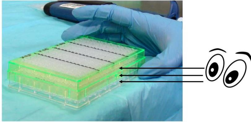
**B-Figure 4.8 检查加药孔中药物注入情况的方式**
