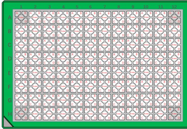
B-Figure 4.4 XFe96探针板俯视模拟图
